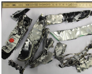
Zewnętrzne elementy HDD: H-3
